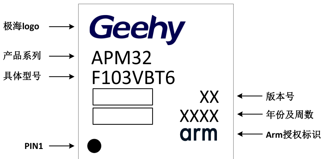
图 22 LQFP100 - 100 引脚，14 x 14mm 封装标识
