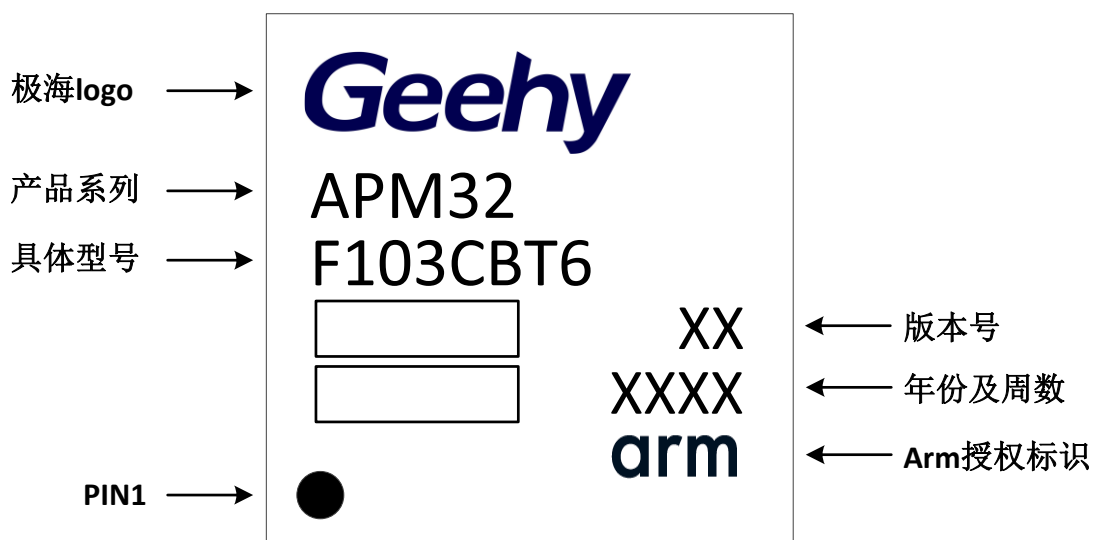
图 28 LQFP48 - 48 引脚, 7 x 7 mm 标识图
